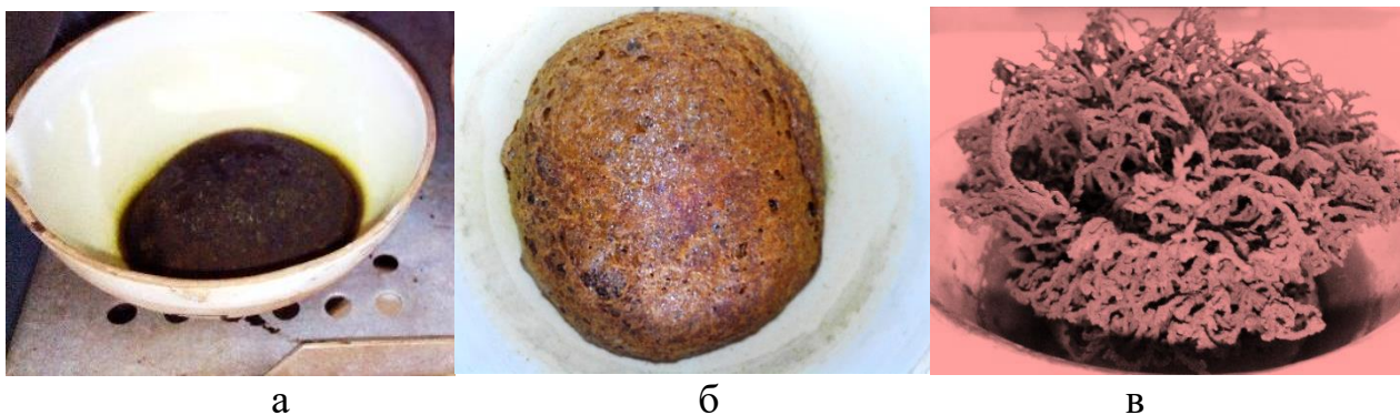
Рис. 1. Етапи синтезу порошку перовскиту \text{LaFe}_{0.5}\text{Cr}_{0.5}\text{O}_3 : а – ксерогель, б – ксерогель за температури 150^\circ\text{C} , в – синтезований порошок після автогоріння.
