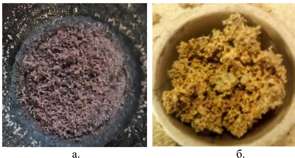
Рис. 3.2. Отримані нанорозмірні порошки \text{LaCrO}_3 (а) та \text{LaFeO}_3 (б).
