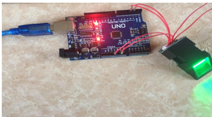
Рис. 1. Схема пристрою ідентифікації за відбитками пальців
