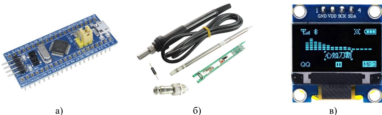
Рис. 1. Основні елементи паяльної станції: а – плата налаштування на мікроконтролері; б – ручка-тримач для жала Hakko T12 з кабелем і роз'ємом MINI MIC 5 PIN, гніздом, вібродатчиком і жалом; в – 128×64 1,3 дюймовий OLED-дисплей модуль.
